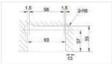
Bisagra de vibel doble acción, para 30 Kg. Fijación a piso y techo. Para puertas de cristal templado de 8 a 12 mm.
