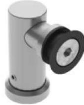
Conector León muro a vidrio para cristal templado. Instalar un conector cada 1.50m de separación máximo, y en caso de que el cristal supere 1m de altura, instalar conectores en la parte superior ó en los laterales. \*Anclar a piso ó muro con taquete expansivo y pija. \*\*Incluye taquete de metal.
