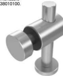
Conector Pachuca muro a vidrio para cristal templado. Instalar un conector cada 1.50m de separación máximo, y en caso de que el cristal supere 1m de altura, instalar conectores en la parte superior ó en los laterales. \*Anclar a piso ó muro con taquete expansivo y pija. \*\*Incluye tornillería.
