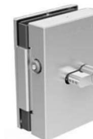
Chapa Zamora para vidrio templado, recomendable para instalación muro a vidrio y vidrio a vidrio en conjunto con la contra 1277C ó al piso. La sujeción al vidrio es mediante presión, lo cual hace que no requiera resaque en el cristal. \*Fabricada con acabados que hacen a este producto resistente a la corrosión y prolonga su vida útil. \*\*Incluye protector plástico para el cristal y juego de llaves.
