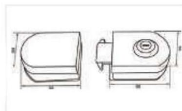
Chapa paleta con contra a vidrio. Entrada de llave solo por un frente. El vidrio no necesita resaque para su fijación. Para puerta abatible y/o corrediza.
